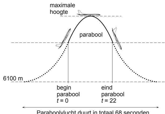
Om te oefenen met gewichtloosheid maken astronauten paraboolvluchten. Het vliegtuig op de foto wordt gebruikt om paraboolvluchten mee te maken.
